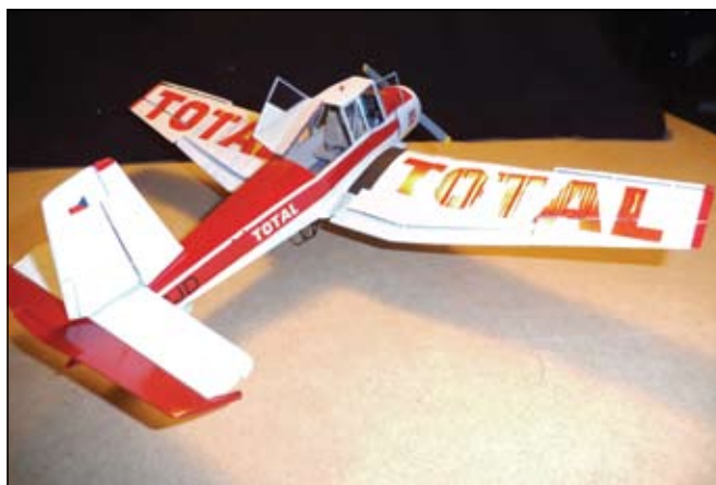
Model letadla pro kamaráda, upravený, původně zemědělský Z-37 Čmelák postavený podle výkresu z plastových destiček v měřítku 1:32
